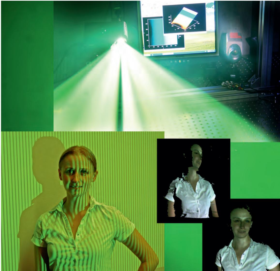
Versuch „3D-Vermessung mit Streifenprojektion“ während der Vorlesung „Optische Messtechnik und Messverfahren“
