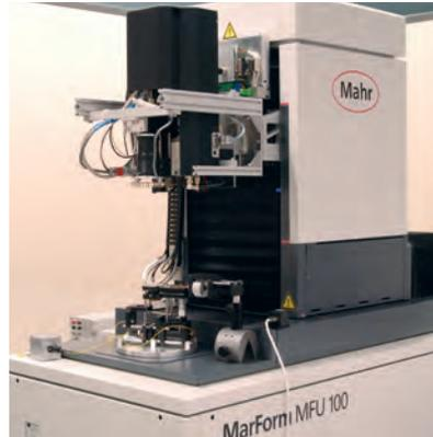
AMMS-Demonstrator für die Inspektion von Mikrolinsen-Arrays und MEMS
