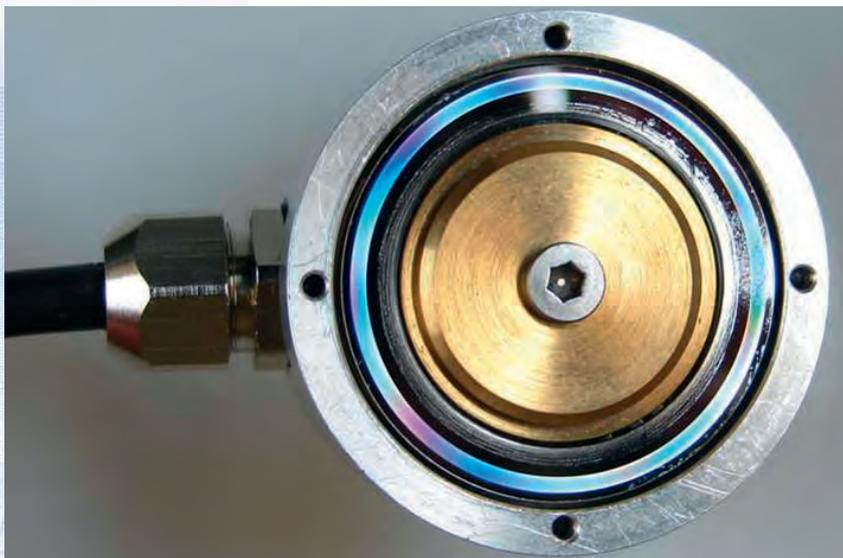
*Inkrementelles Drehwinkelmesssystem mit diffraktiver Maßspur auf Basis von DVD-Herstellungstechnologie.*
