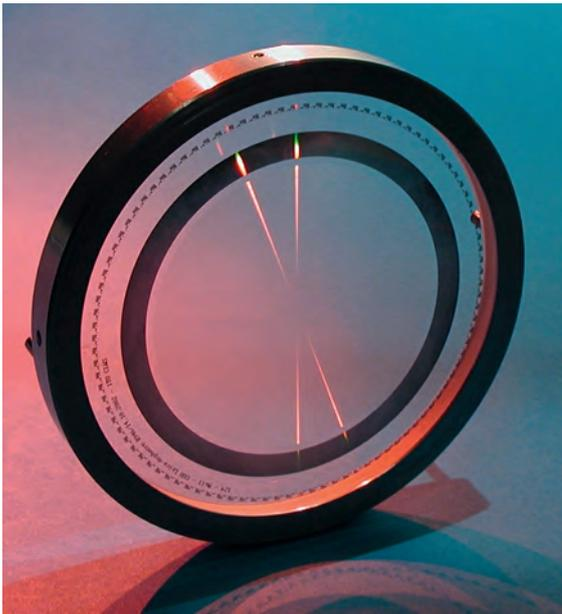
Computergeneriertes Hologramm (CGH) als diffraktive Nulllinse.
