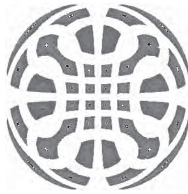
Prüfraum beim Verfahren der verkippten Objektwelle (links). Zu sehen ist das Interferometerobjektiv, das nicht nur einen Fokus erzeugt, sondern eine ganze Reihe von Foki. Diese vielen Wellenfronten erzeugen eine Anzahl von Interferogrammen (rechts) und erlauben es, den Prüfling in wenigen Sekunden flächig mit hoher Präzision zu vermessen.
