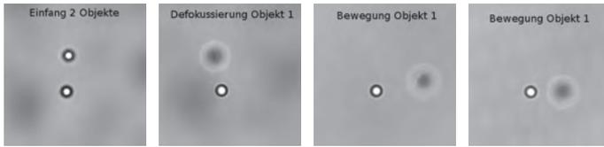
Abb. 2: Bewegung zweier Objekte im dreidimensionalen Raum. Bei Verschiebung in axialer Richtung erscheint das Objekt aufgrund der Defokussierung im Mikroskop unscharf.
