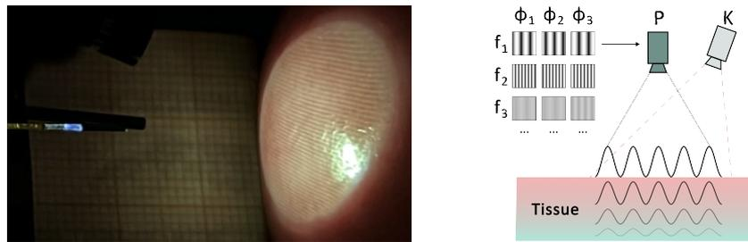
Abbildung 1: Links: Streifenprojektion auf Gewebe mittels miniaturisiertem Streifenprojektor (V. Aslani), Rechts: SFDI-Prinzip
